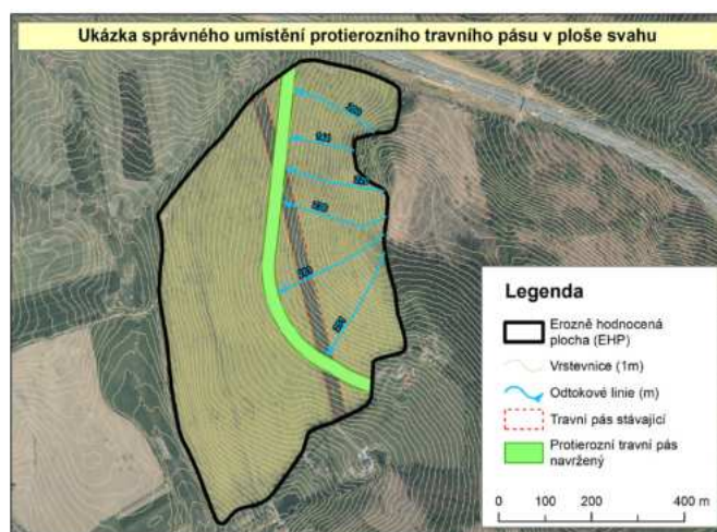
(Obrázek 5. Ukázka správného návrhu a umístění protierozního travního pásu v ploše pozemku)
