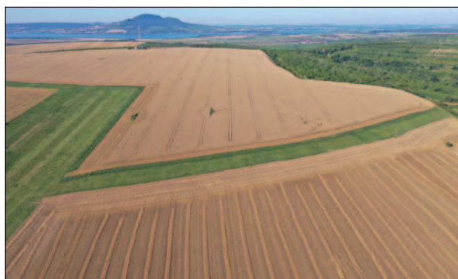
Obrázek 2. Soustava zatravněné údolnice a 4 protierozních travních pásů v lokalitě Hustopeče u Brna – Starovice (experimentální povodí VÚMOP, v.v.i.)
